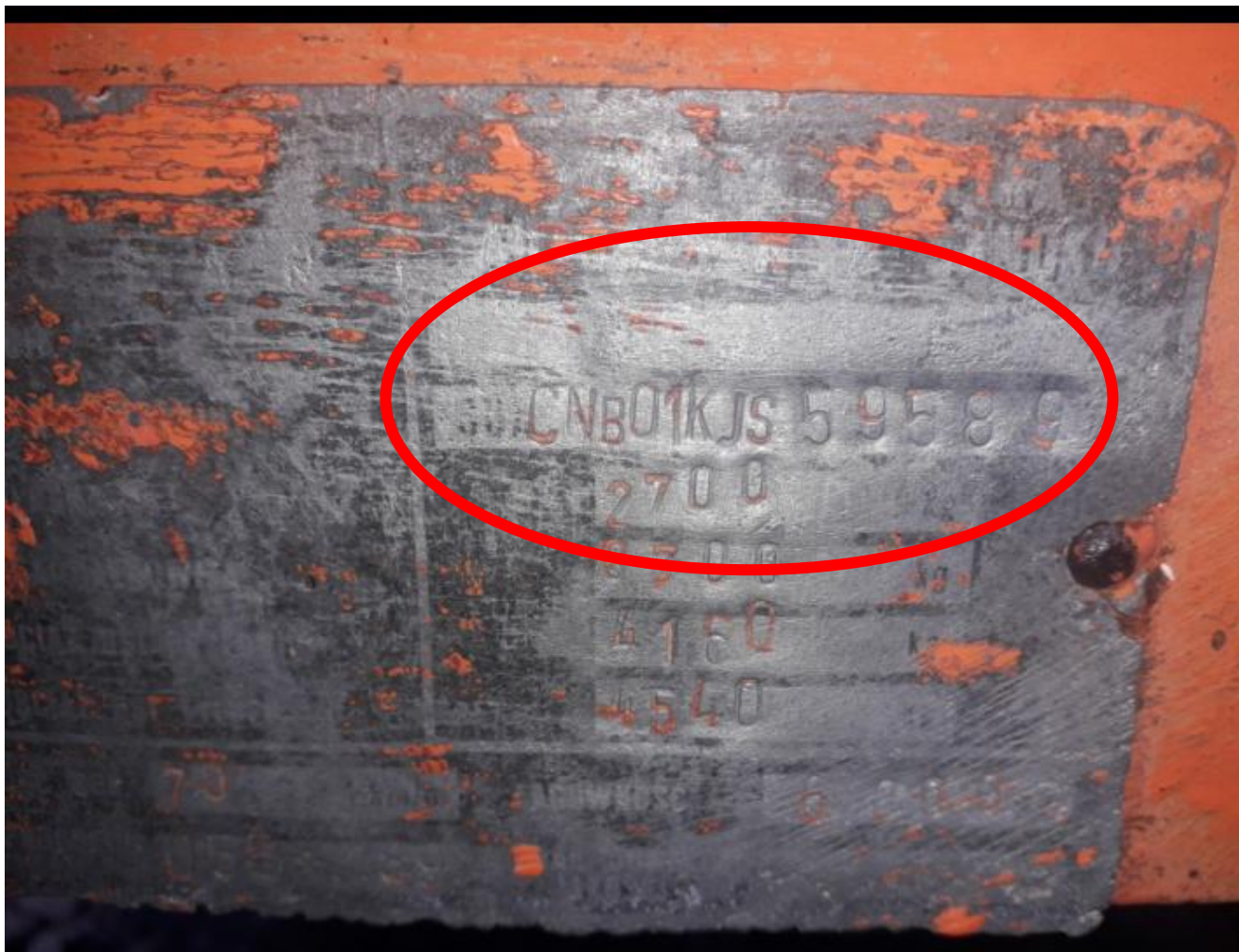
Fot. nr 1. Pole numerowe - tabliczka znamionowa pojazdu.
