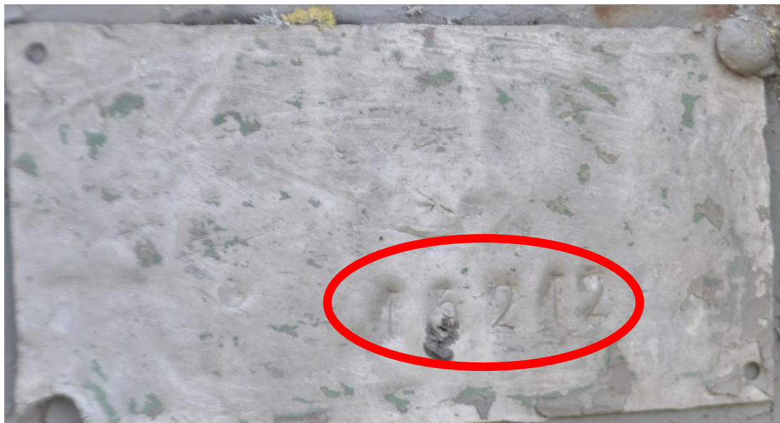
Fot. nr 1. Pole numerowe - tabliczka znamionowa pojazdu.
