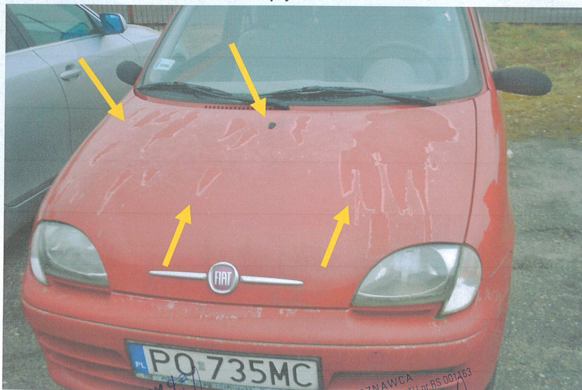
Fot. nr 3. Badania pojazdu – zakres uszkodzeń
